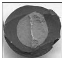
破断面 (外皮が CMC 含有層)
